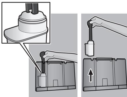
**Opmerking:** Door het filter te spoelen, is tegelijk ook de instelling voor de indicatie van de filtervervanging geactiveerd.
