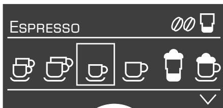
Nella riga di stato **5a** del display **5** viene visualizzato il nome del tipo di bevanda e il valore impostato per l'intensità, ad esempio **00** e per la quantità, ad esempio **1**. La riga di selezione **5b** rappresenta i simboli per la selezione delle bevande.
