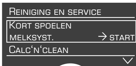
Het melksysteem **10** kan automatisch worden voorgereinigd.
