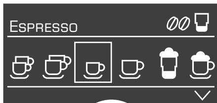
In de regel "status" **5a** van het display **5** wordt de naam van de drank en de ingestelde sterkte, bijv.  $\text{00}$ , en hoeveelheid, bijv.  $\text{\text{1}}$ , vermeld. In de regel "keuze" **5b** verschijnen symbolen voor de drankkeuze. De pijltjes in de regel "navigatie" **5c** geven aan in welke richting er zich nog menu-items bevinden.
