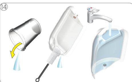
Вылейте жидкость из контейнера для воды и промойте его. Промойте и очистите емкость для воды. После этого заполните ее свежей питьевой водой и поместите в машину.
