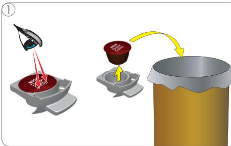
Остановите приготовление, вытяните держатель капсул и проверьте капсулу. В капсуле должно быть только одно отверстие. Выбросьте капсулу, если в ней более одного отверстия.
