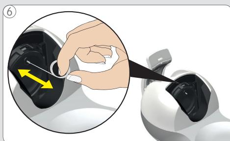
Разблокируйте инжектор с помощью иголки для очистки.
