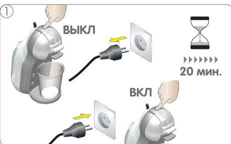
Выключите машину. Проверьте, чтобы капсула не была заблокирована (смотри страницу 10). Отключите машину от источника питания и подождите 20 минут. После этого вставьте вилку в розетку и включите машину.
