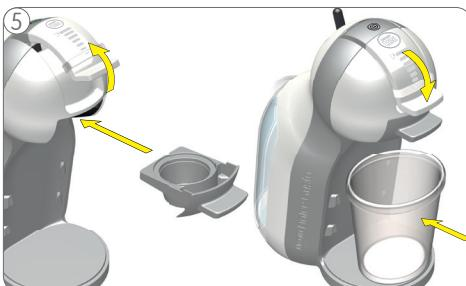
Откройте блокирующую рукоятку и вставьте пустой держатель капсулы. Опустите фиксирующий рычаг. Вставьте контейнер для воды в кофе-машину, предварительно наполнив его.
