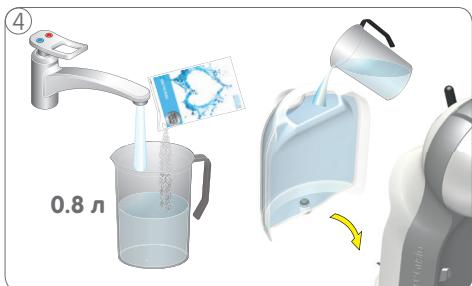
Смешайте в контейнере для воды 0,8 л воды и жидкость для очистки от накипи. Налейте данный раствор в емкость для воды и вставьте ее в машину.
