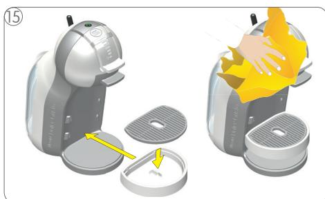
Поместите решетку поддона на поддон. Затем установите поддон на предназначеннное место в машине. Очищайте машину мягкой влажной тканью. После этого высушите ее мягкой сухой тканью.
