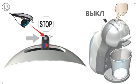
Дождитесь пока рычажок вернется в центральное положение. После окончания промывки, индикатор будет мигать красным светом. Дождитесь, пока индикатор кофе-машины перестанет мигать и станет зеленым. Затем выключите кофе-машину.
