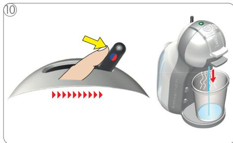
Передвиньте рычажок вправо, чтобы начать промывку кофе-машины. Дождитесь, когда рычажок вернется в центральное положение и подача воды прекратится.
