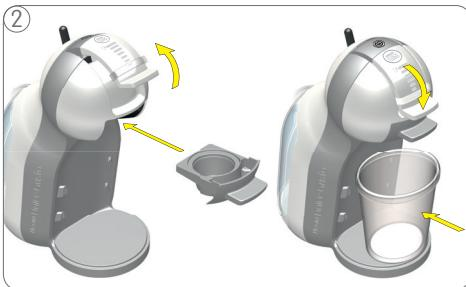
Откройте блокирующую рукоятку и вставьте пустой держатель капсулы. Закройте блокирующую рукоятку. Вставьте контейнер для воды в кофе-машину, предварительно наполнив его.
