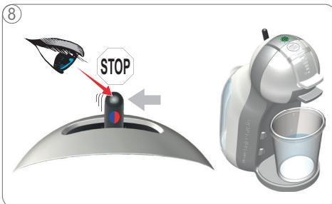
Дождитесь пока рычажок вернется в центральное положение. После того, как цикл очистки от накипи завершен, индикатор кофе-машины мигает зеленым в течение 2 минут.
