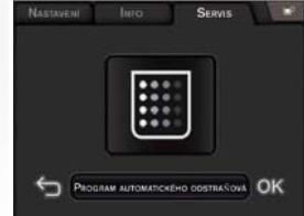
**⚠️ Upozornění:** Během odstraňování vodního kamene v zařízení nebo při čištění okruhu na kávu může voda velmi prudce vystříknout. Podle potřeby umístěte na nádobu odkapávače papírový ubrousek.
