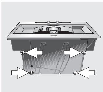
Если это не так, то Вы можете вывернуть 4 ножки с нижней стороны прибора большим ключом с шестигранником и, таким образом, выровнять прибор.
