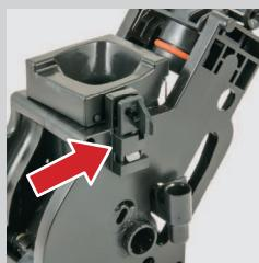
**10** Убедитесь, что крючок для блокировки блока приготовления кофе находится в правильном положении; для проверки его положения нажмите и удерживайте кнопку «PUSH» до тех пор, пока не почувствуете, что произошел захват. Убедитесь в том, что фиксатор поднялся вверх до упора. В противном случае попробуйте еще раз.
