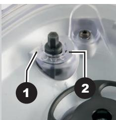
**2** Отметки, имеющиеся внутри емкости для кофе в зернах, указывают заданную степень помола. Можно выбрать 5 различных степеней помола, начиная с положения 1 для крупного помола и более легкого вкуса, и заканчивая положением 2 для мелкого помола и более насыщенного вкуса.
