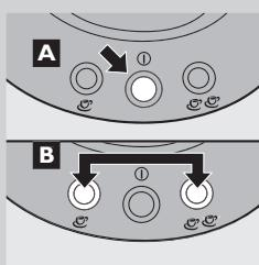
**9** Нажмите кнопку включения / выключения  $\textcircled{1}$  and , затем одновременно нажмите кнопки приготовления 1 чашки Ⓛ и 2-х чашек Ⓛ Ⓛ .
