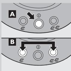
**4** Нажмите кнопку включения / выключения **①** and , затем одновременно нажмите кнопки приготовления 1 чашки **ⓐ** и 2-х чашек **ⓐ Ⓛ** .
