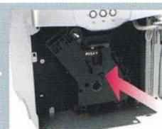
Промойте устройство приготовления, высыпите его и установите на место. При установке не нажимайте PUSH.
