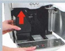
Снимите контейнер использованного кофе и промойте его под струей воды.
